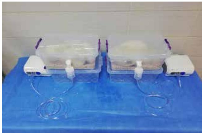
Şekil 1. Bir nebulizör ile uygulama için hazırlanmış inhalasyon kapları
